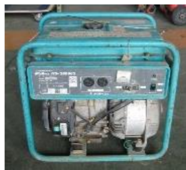
⑮ デンヨ 発電機 2.6KVA
