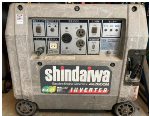
⑦ 新ダ イ 発電機インバータ防音2.6KVA
