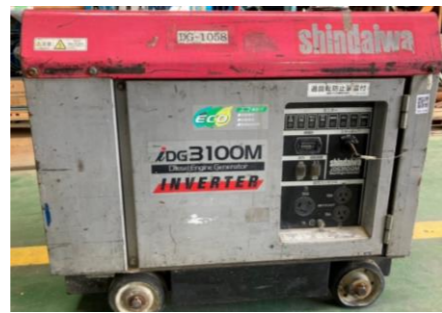
③ 新ダ インバータータイプセル発電機 3.1KVA
